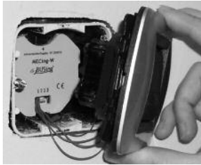
Montaje en pared Tras el propio mecanismo.
